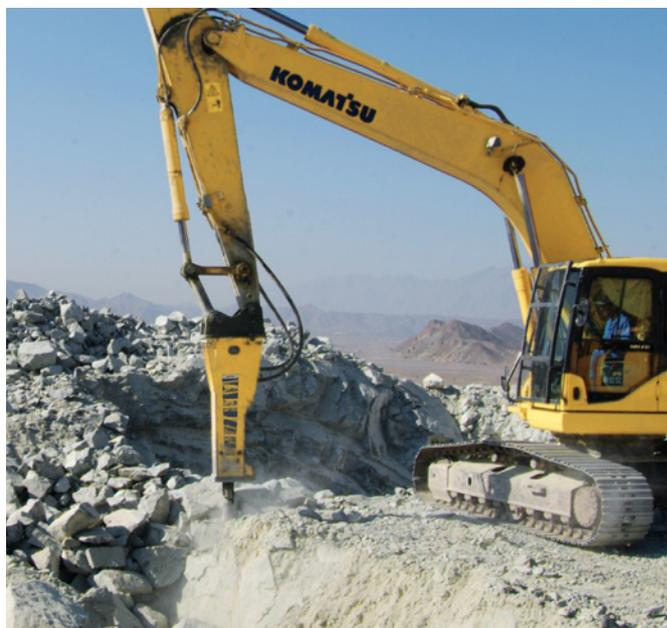
El sistema patentado **StartSelect** permite al operario ajustar el funcionamiento al arranque y la parada dependiendo de las condiciones del suelo.
