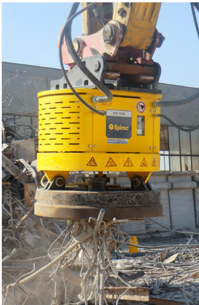
La fácil instalación de los imanes hidráulicos los convierten en el equipo ideal para trabajos de demolición, desguaces e instalaciones de reciclaje.
