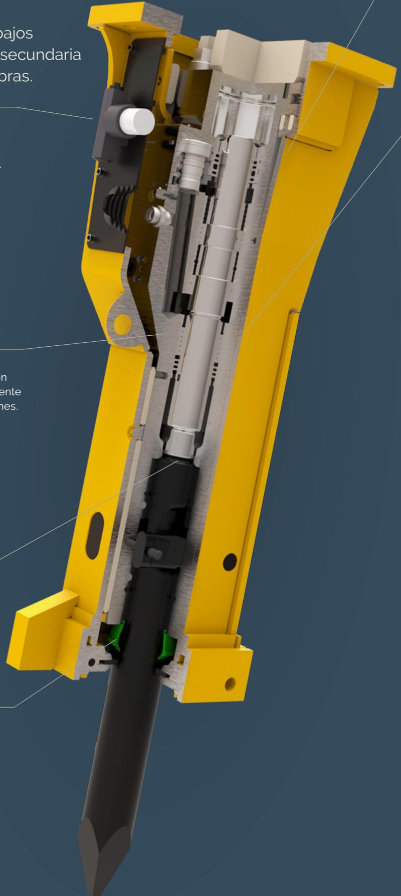
El sistema de cambio de longitud de la carrera del pistón **AutoControl** ajusta automáticamente el equilibrio final durante el funcionamiento y optimiza los resultados.
