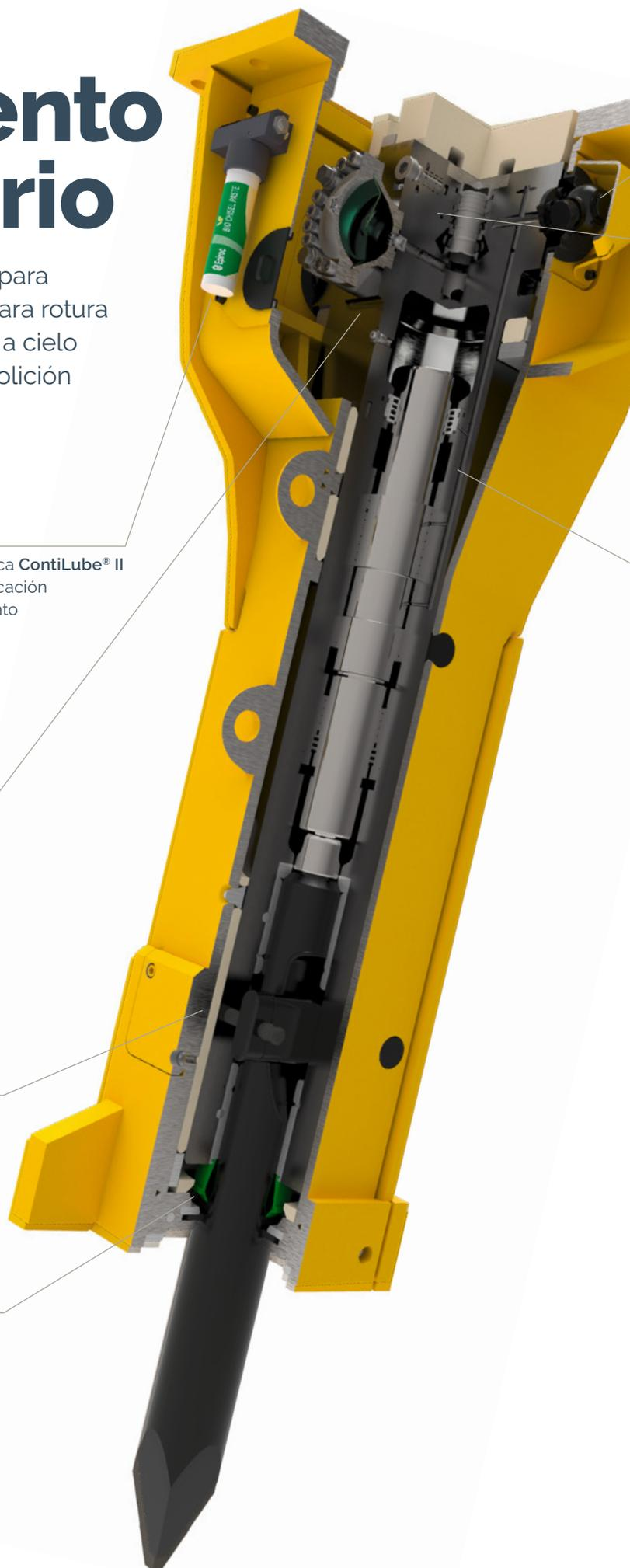
La válvula de cierre de presión integrada **PowerAdapt** evita sobrecargas.
