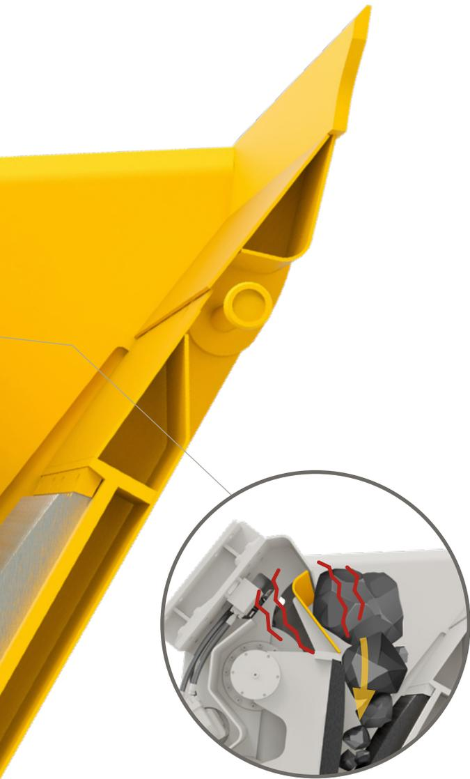
Para aumentar la producción, una **placa deslizante móvil** guía continuamente el material hasta la mandíbula de trituración.
