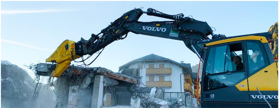
El uso a largo plazo queda garantizado por la construcción extremadamente robusta de los pulverizadores de demolición. Las piezas de desgaste se pueden cambiar fácilmente in situ.
