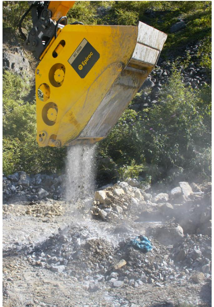
Nuestras cucharas trituradoras ofrecen una combinación de bajo mantenimiento y alto rendimiento. La trituración in situ también supone una reducción de los costes de transporte y depósito de residuos en vertederos.
